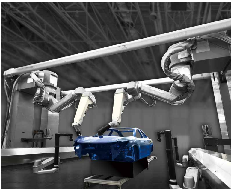
P-1000 i A与开启车门用P-20 i B共同完成车体喷涂
