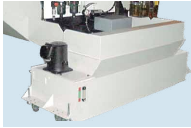
冷却剂装置（水槽部分）
