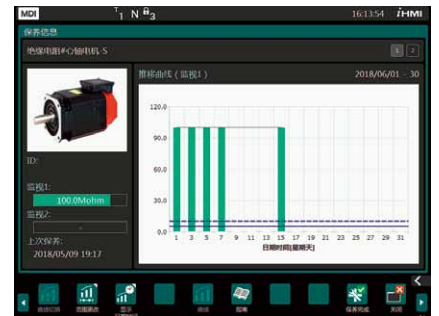
绝缘劣化检测功能画面
